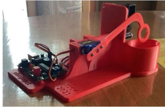
**Aufbau:** Er besteht aus einem Modell und aus einer Platine mit Servo und Turboladerventilator.
